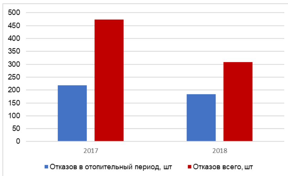
Рис. 1.1.1. Статистика отказов тепловых сетей Новогорьковской ТЭЦ
