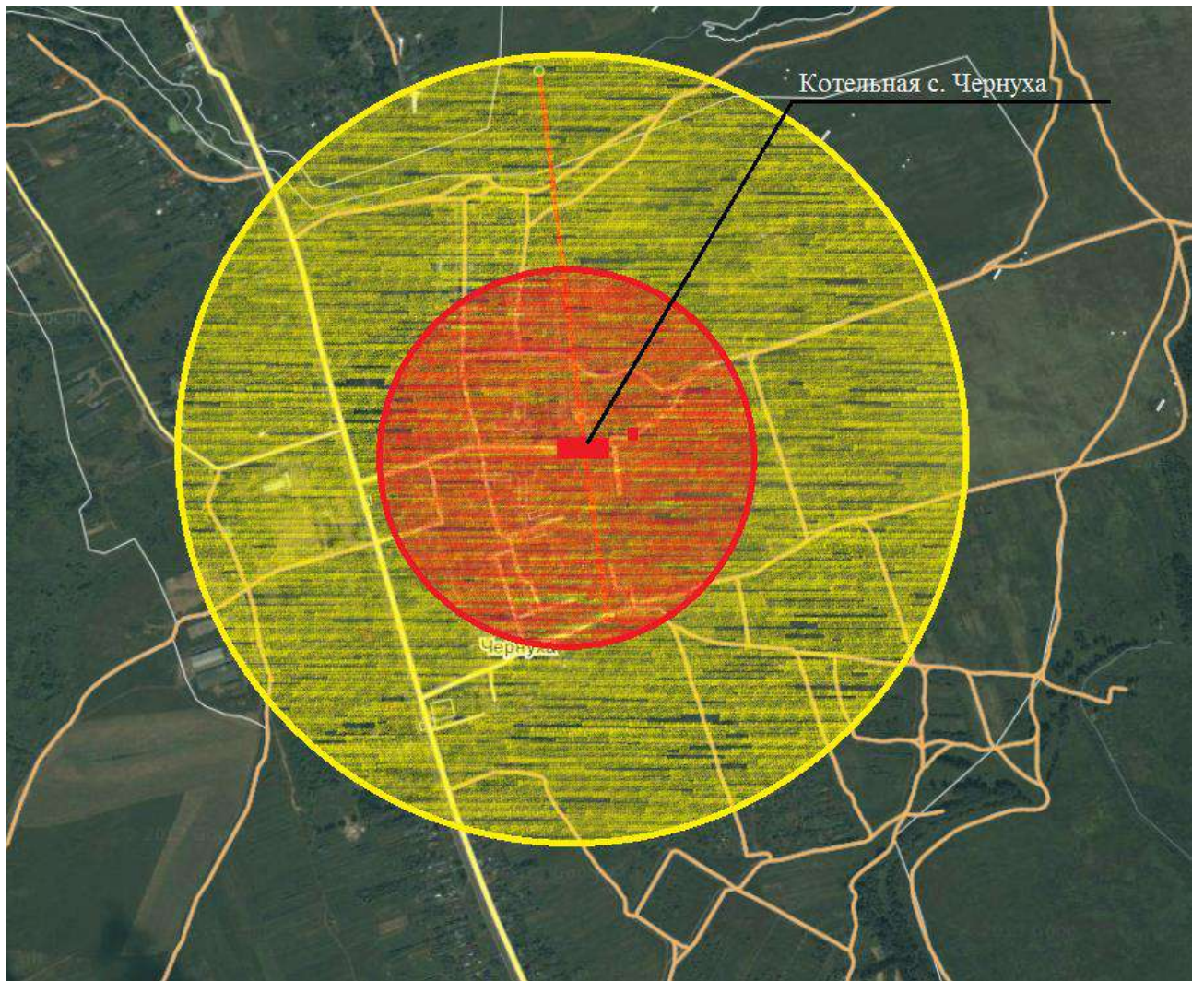
Рис. 2.1.1. Эффективный радиус теплоснабжения котельной с. Чернуха
