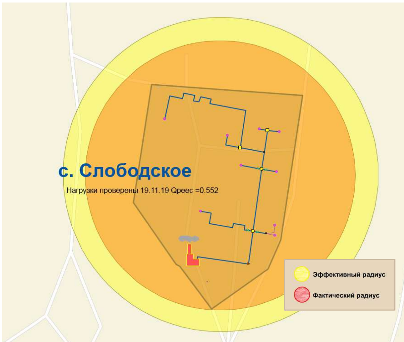
Рис. 2.5.2. Эффективный радиус теплоснабжения котельной с. Слободское»
