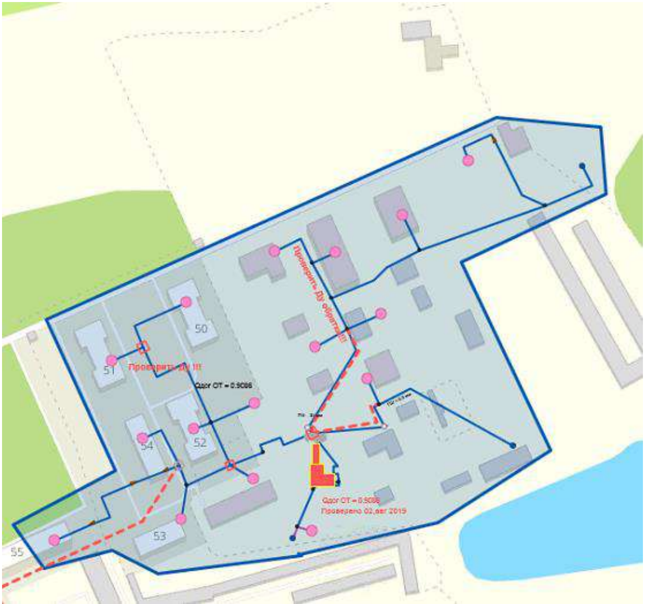
Рис. 2.1.2. Зона действия котельной Военная часть пос. Дружный
